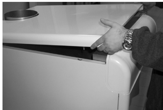
Fig. 4 - Sollevare con una pressione dal basso verso l'alto e togliere il coperchio che è trattenuto ai fianchi della caldaia con piolini ad incastro.
