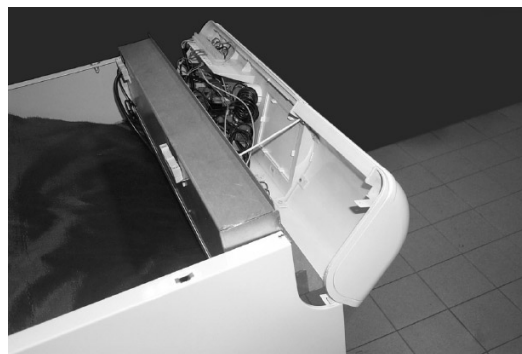
Fig. 6 - Far ruotare in avanti il pannello comandi.
