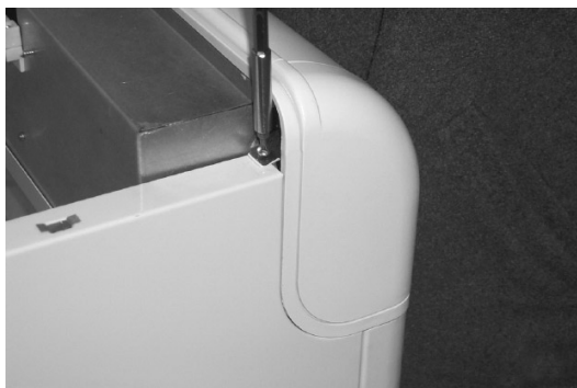
Fig. 5 - Svitare e togliere le due viti e le due piastrine che tratteggiano il pannello comandi.
