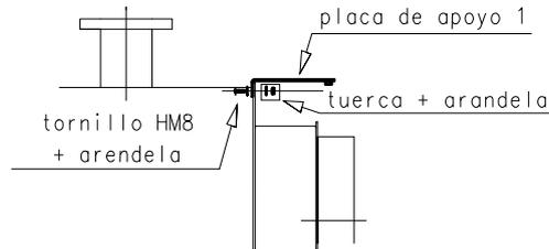
2° Fijar la placa de apoyo 2 en la placa 1 con los tornillos HM10 sin apretarlos demasiado de tal modo que las 2 placas puedan deslizarse una sobre la otra.
