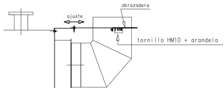
5° Ajustar la placa 2 en la placa 1 para obtener un juego de 3 mm máximo entre la salida vertical de humos y la virola de humo de la caldera.
