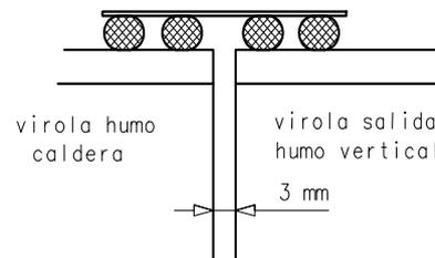
7° **NOTA:** El montaje de la salida vertical de humos no está dimensionado para soportar elementos de fumistería.
