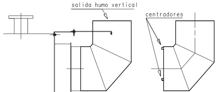
4° Fijar la abrazadera en la placa de apoyo 2 con los tornillos HM10 para sujetar la salida vertical de humos.
