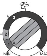
Per mezzo di questa manopola è possibile regolare la temperatura di prelievo dell'acqua calda sanitaria:
