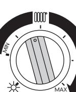
**Режим Зима** (производство ГВС и настройка температуры отопления).
