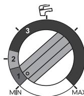
Bu düğme ile sıcak kullanım suyunun ısısı ayarlanır:
