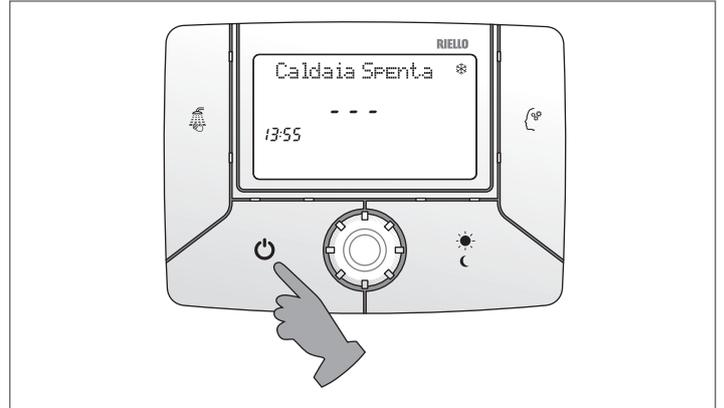
Restando attive l'alimentazione elettrica e quella del combustibile, la caldaia sarà protetta dal sistema antigelo. Il display mostrerà sequenzialmente sulla riga di comunicazione: caldaia spenta, antigelo ON, l'icona
