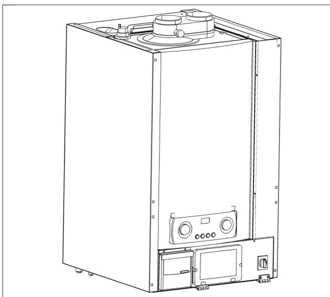
Per accedere alla parte frontale della caldaia in caso di manutenzione è necessario togliere la lamiera frontale **B**.
