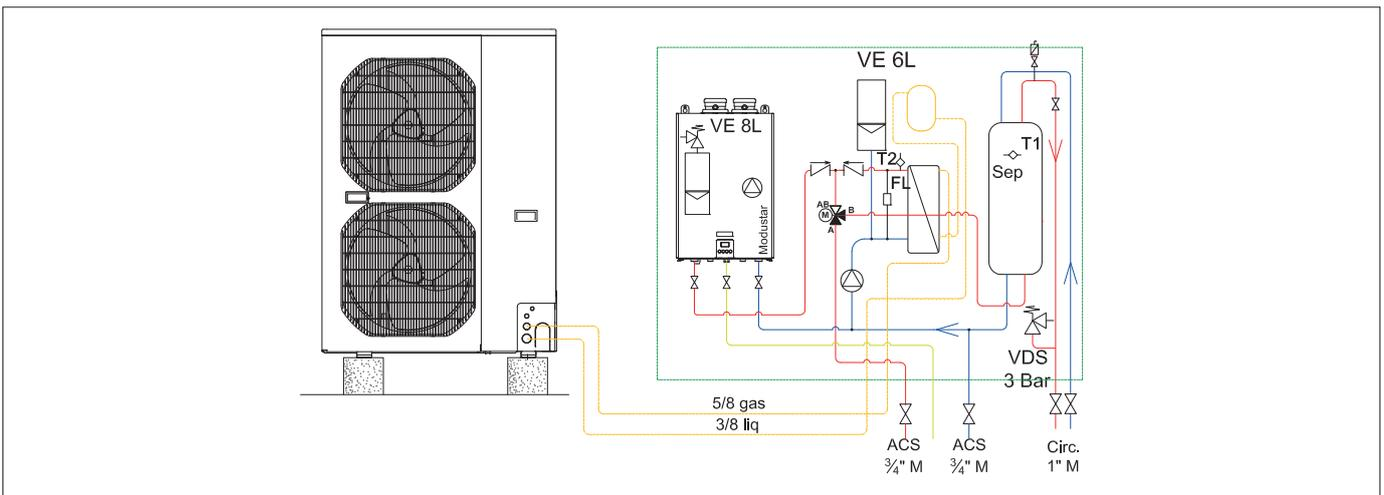
Con caldaia "Solo" senza separatore idraulico
