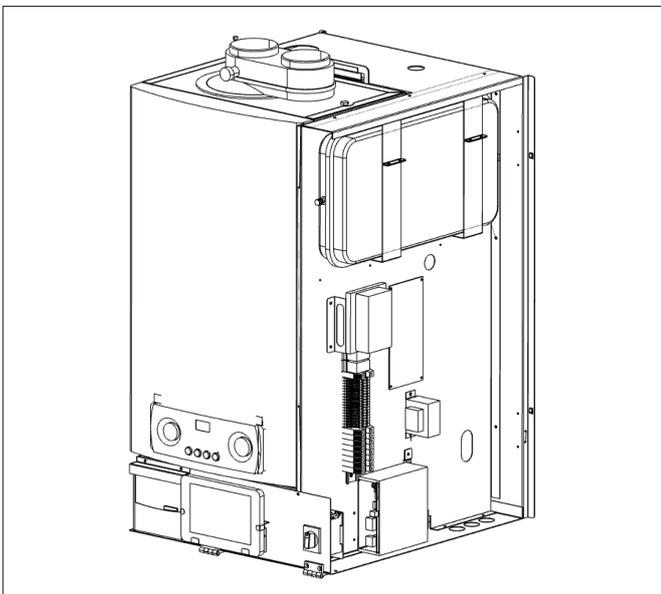
Togliendo il pannello **D** è possibile accedere alla parte elettronica della Libra Hybrid e alla parte del vaso d'espansione (6 litri prevaso 1,5 bar).
