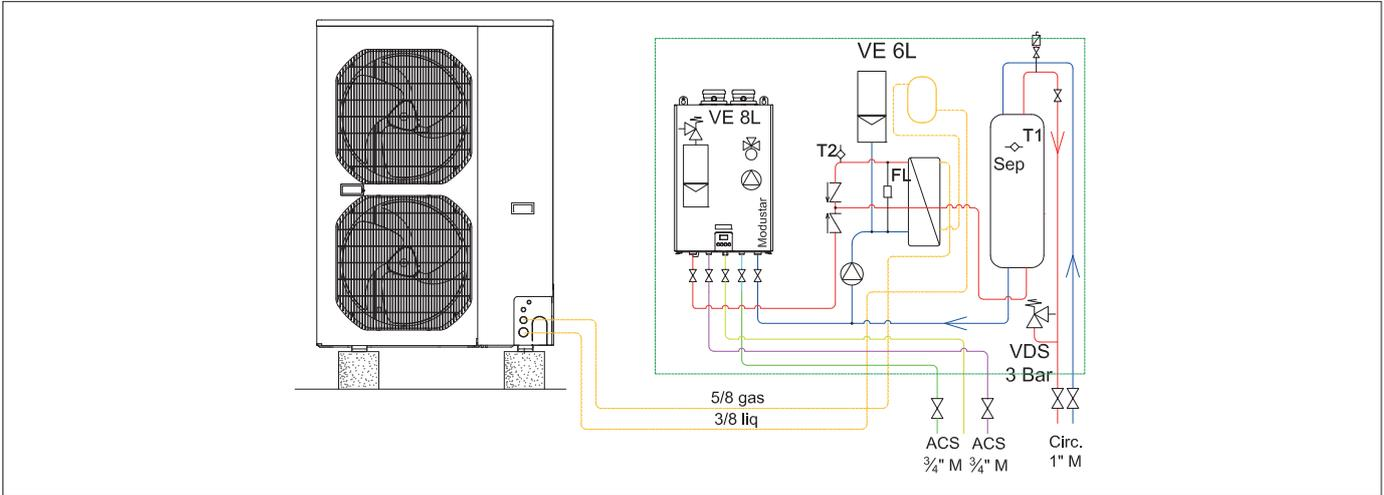
Con caldaia "Solo" con separatore idraulico
