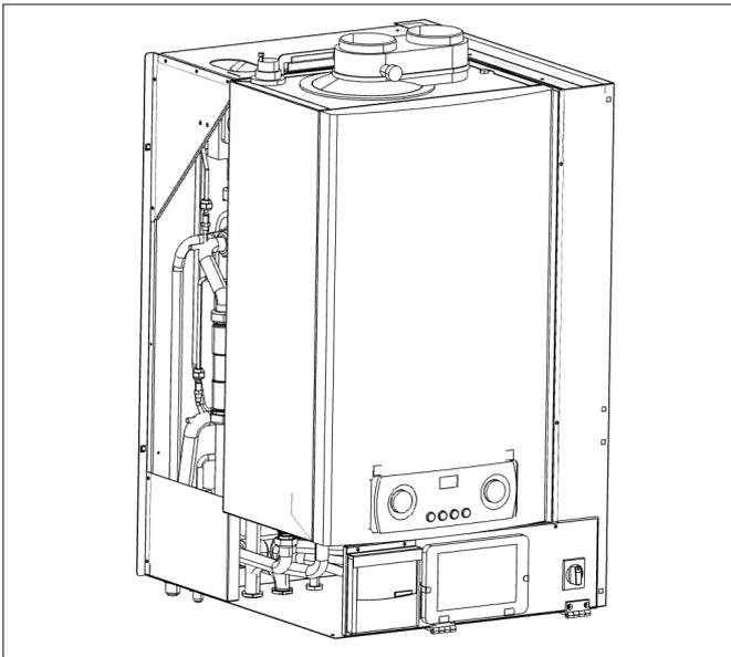
Togliendo la lamiera laterale sinistra **C** è possibile accedere alla parte posteriore del modulo idraulico (scambiatore, pressostato differenziale, elettrovalvola).
