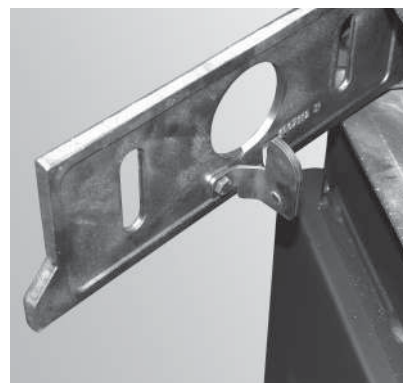
Fig. 14 Avvitare il fissaggio all'interno della griglia con 2 viti a testa esagonale M8 x 16 e dadi M8
