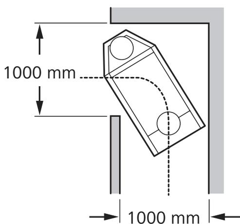
La caldaia può essere disassemblata per ottenere parti più piccole e agevoli da trasportare. Senza imballo, la caldaia ha una larghezza di 720 mm (senza involucro di 700 mm) e può passare attraverso tutte le porte di misure standard.
