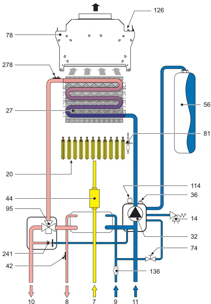
fig. 26 - Circuito idraulico
