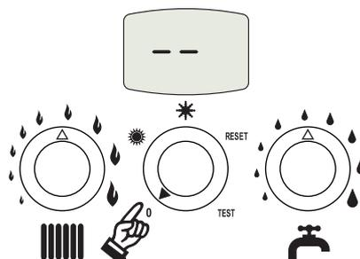
fig. 7 - Spegnimento caldaia
