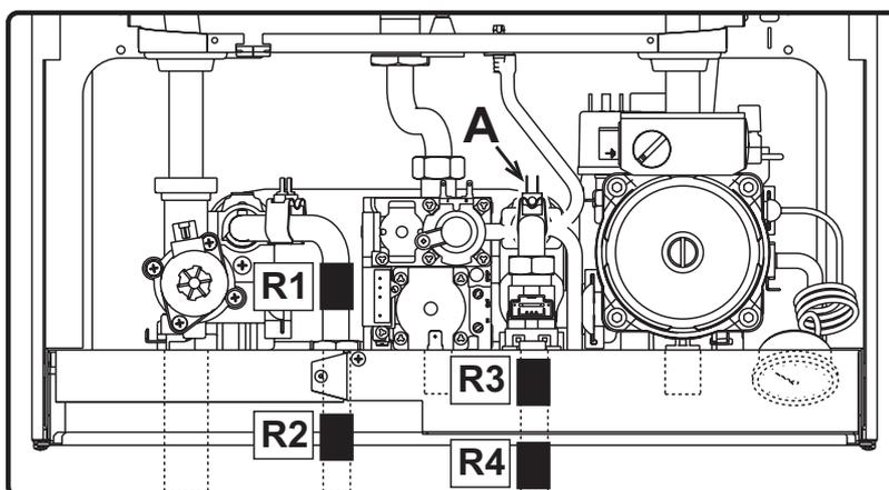
fig. 19 - Posizionamento riscaldatori e termostato antigelo
