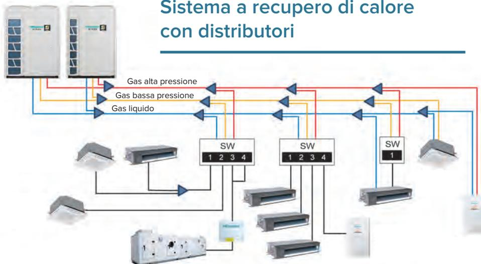
Il sistema Hisense Hi-FLEXi serie S a 3 tubi permette di avere simultaneamente raffreddamento e riscaldamento a valle della medesima unità esterna: il sistema permette di recuperare il calore dagli ambienti raffrescati e di dirtarlo mediante il flusso del refrigerante agli ambienti in riscaldamento. Mediante l'utilizzo di distributori a più attacchi è possibile alimentare diversi terminali con risparmio dei costi di materiale e di installazione.
