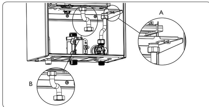
Fig. 30b - Smontaggio bruciatore
