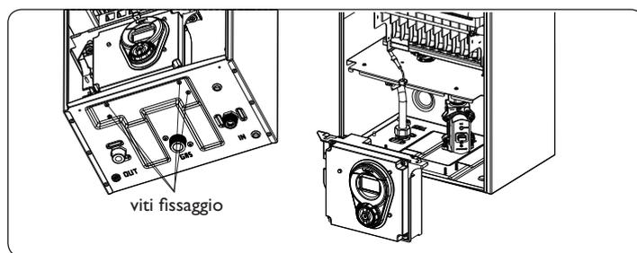
Fig. 29 - Smontaggio ventilatore
