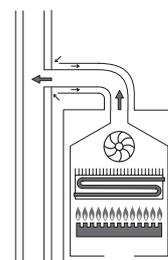
**C12 - C12x** Scarico fumi ed aspirazione aria comburente a parete mediante condotti orizzontali di tipo coassiali o sdoppiati con uscite posizionate abbastanza vicine da essere sottoposte a condizioni di vento simili.
