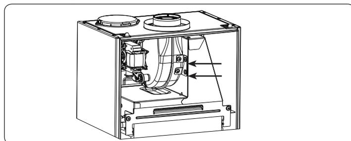
Fig. 30a - Smontaggio bruciatore
