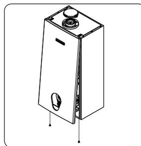
Fig. 27 - Accessibilità alla scheda elettronica
