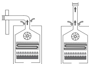
**B32** Condotto concentrico con scarico fumi in canna fumaria e aspirazione aria comburente direttamente nell'ambiente dove l'apparecchio è installato.
