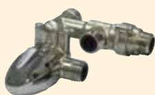
Il Kit solare per caldaie istantanee permette di bypassare la caldaia nel caso in cui la temperatura dell'acqua dal serbatoio solare sia maggiore di 48 °C. E' costituito da una deviatrice termostatica e da una miscelatrice termostatica regolabile, fra loro integrate.
