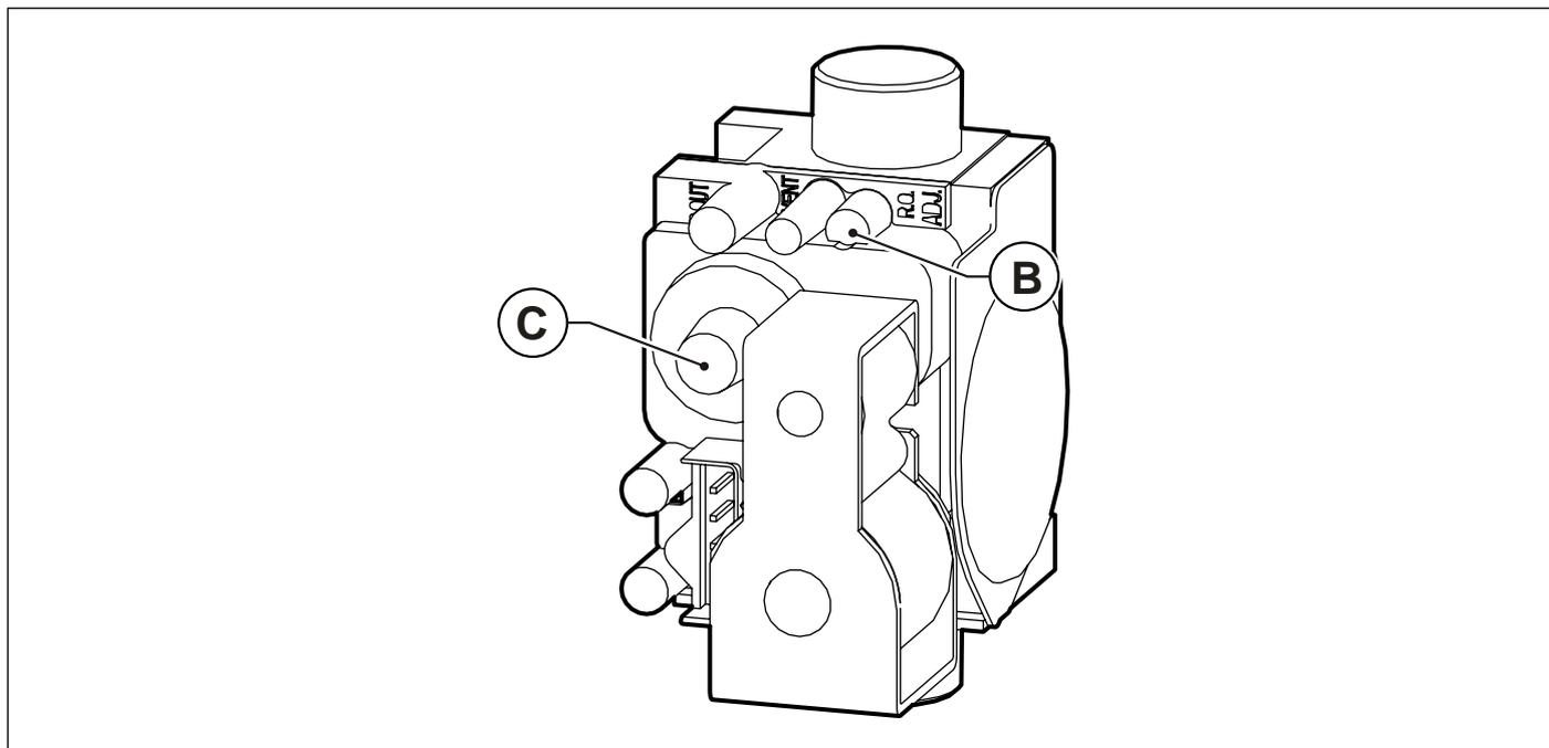
Fig. 39 Regolazione valore anidride carbonica
