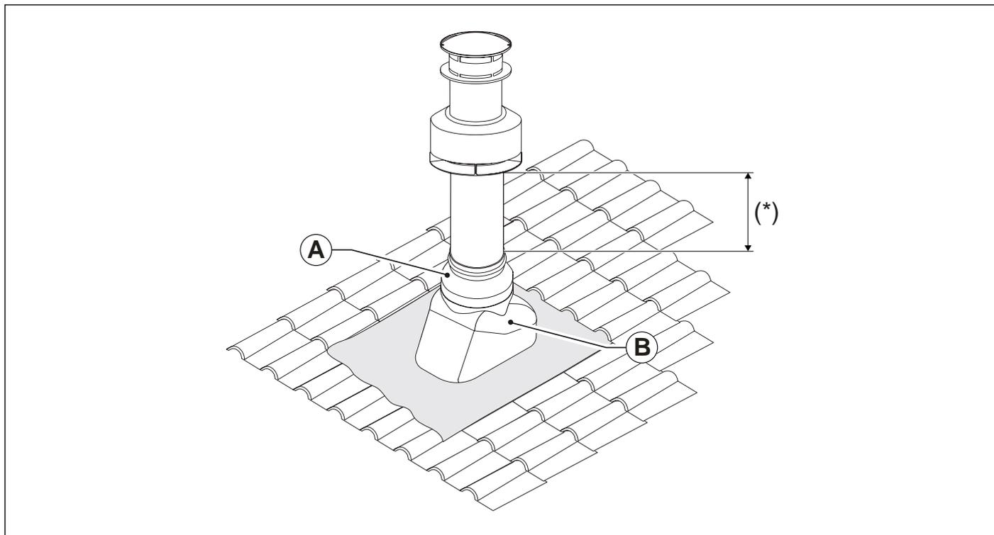
Fig. 15 Installazione camino a tetto
