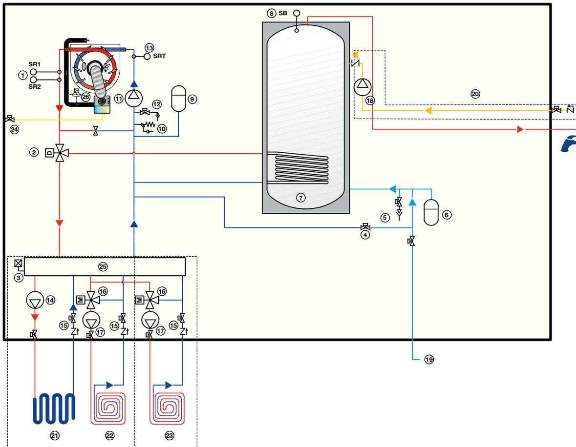
Fig. 8 Schema di funzionamento caldaia
