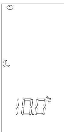
4. Premendo i tasti +/- RISCALDAMENTO si modificano i valori della “temperatura notte”.
