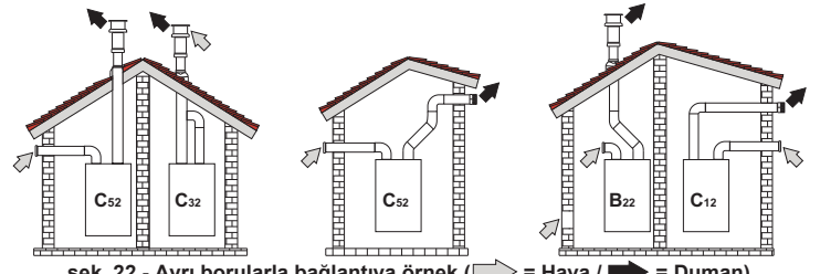
şek. 22 - Ayrı borularla bağlantıya örnek (→ = Hava / → = Duman)
