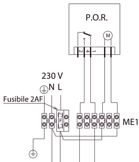
Il programmatore orario esterno e il termostato ambiente andranno inseriti come indicato dallo schema dopo aver tolto il cavallotto presente sulla morsettieria a 6 poli. I contatti del termostato ambiente e del programmatore orario devono essere dimensionati per V= 230 Volt
