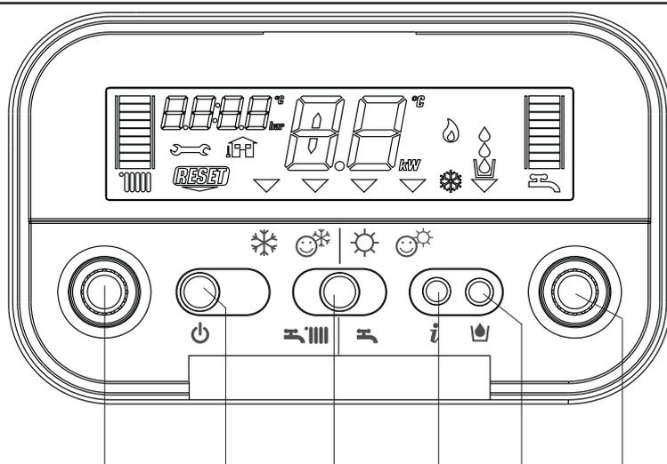
Selettore temperatura acqua circuito riscaldamento
