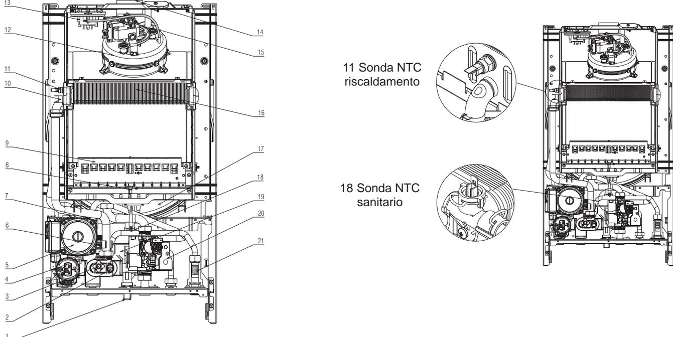
11 Sonda NTC riscaldamento
