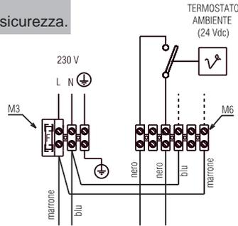
Le utenze di bassa tensione andranno collegate come indicato in figura sul connettore CN6.
