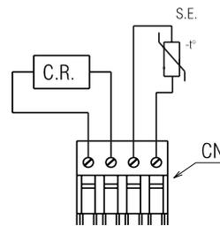
Le utenze di bassa tensione andranno collegate come indicato in figura sul connettore CN6.
