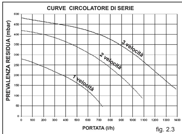
Si tenga presente che la caldaia funziona correttamente se nello scambiatore del riscaldamento si ha una sufficiente circolazione d'acqua.
