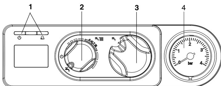
1 Led segnalazione stato caldaia
