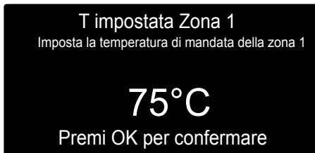
Modifica temperatura acqua calda riscaldamento dal menu utente
